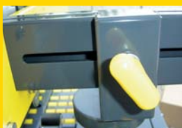
Doppelte seitliche Führungsrollen mit verstellbarer Fixierung...
